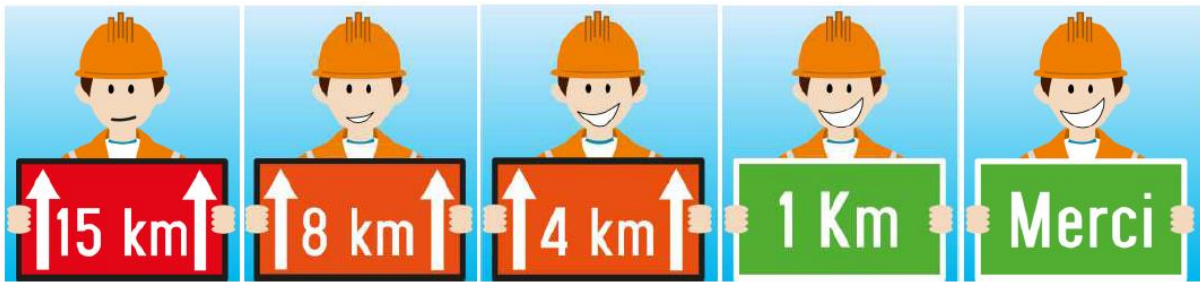
IL. Indication de longueur de chantier
