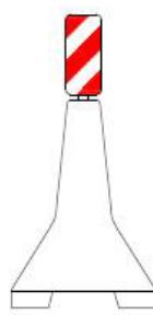
Die Baken, die über dem räumlichen Trennzeichen angebracht werden, sind maximal 30 m voneinander entfernt. Sie haben eine Mindestgröße von 400 cm<sup>2</sup> auf dieser Länge von 30 m. Sie bestehen aus abwechselnd roten und weißen Streifen. Die Retroreflektion dieser Streifen genügt der Tabelle 2-3A von PTV 662.
