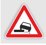
A8 accotement non stabilisé
