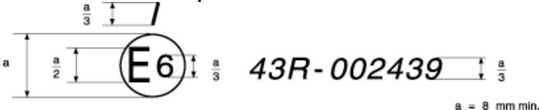
La marque d'homologation ci-dessus, apposée sur un pare-brise en verre trempé, indique que l'élément en question et son installation sur le véhicule ont été homologués conformément aux prescriptions sous le numéro d'homologation 43R-002439 par la Belgique.
